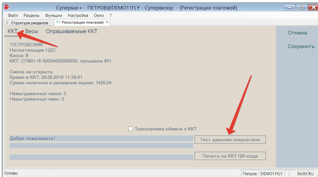
При нажатии на данную кнопку, на дисплей выводится текст, введенный в окне возле кнопки, или показывается ошибка, если дисплей не подключен или неисправен.
