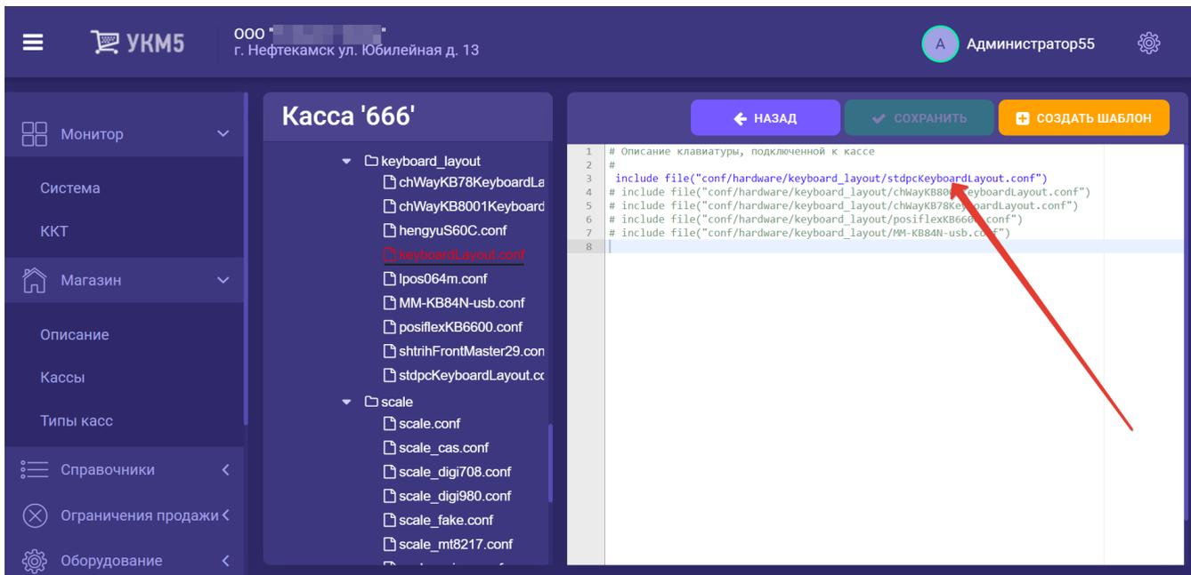
В конфигурационном файле с раскладкой актуальной клавиатуры по адресу: **hardware\keyboard\_layout\файл актуальной раскладки** необходимо указать назначение определенной клавиши, например:
